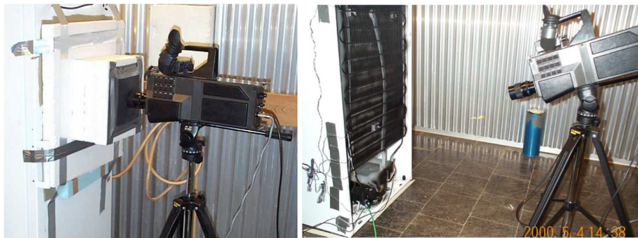
Figura B-1: Posición de la cámara IR, para la grabación de las temperaturas del evaporador y condensador [40].
