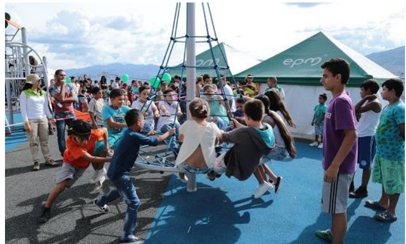
Estructura tensegrity. Sistema rotatorio construido con tubos metálicos y cuerdas.
