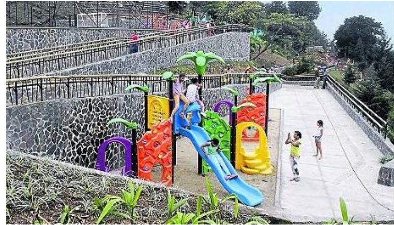
Parque de exterior. Parque infantil hecho de polietileno rotomoldeado, compuesto por varios módulos funcionales.
