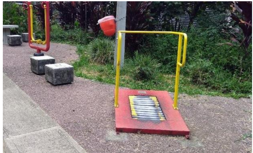
Caminadora urbana. Caminadora hecha con rodillos. Acero y pintura anticorrosiva. Bioparque Ana Díaz
