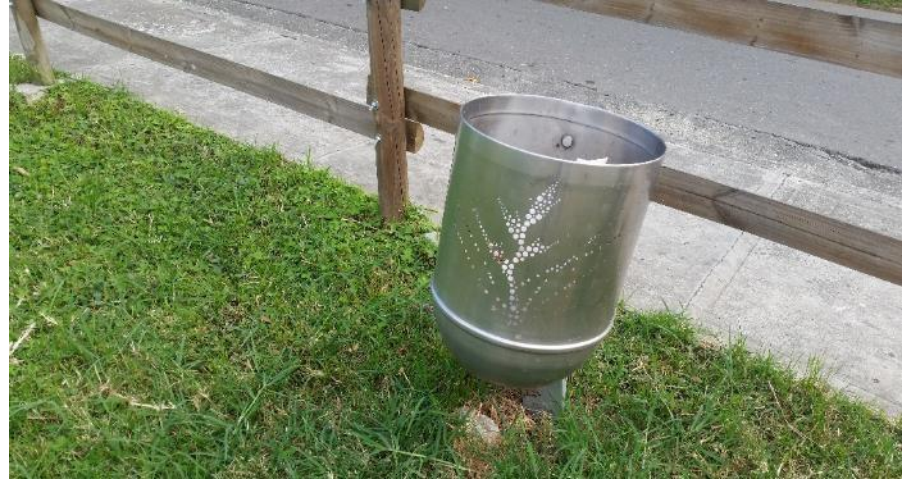
Basurera pivotante. Basurera de acero inoxidable y base en fundición de hierro. Empotrada en suelo blando. Ubicada al borde de la calle.
