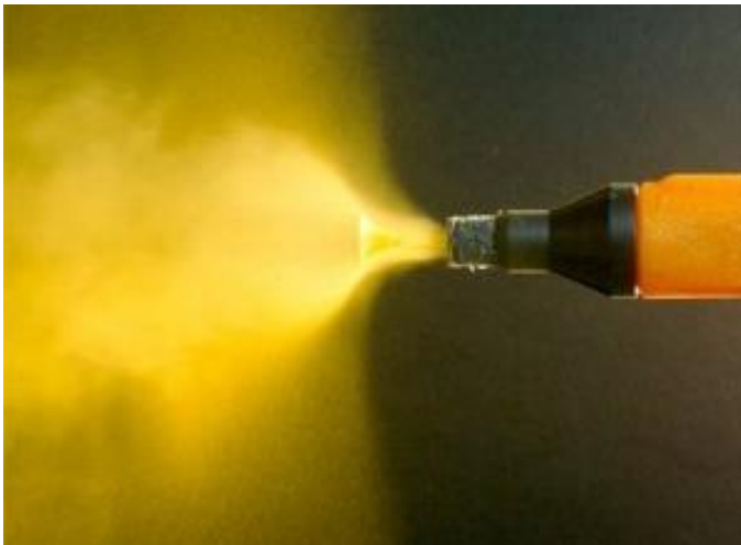
Aplicación de pintura electroestática por medio de pistola.
