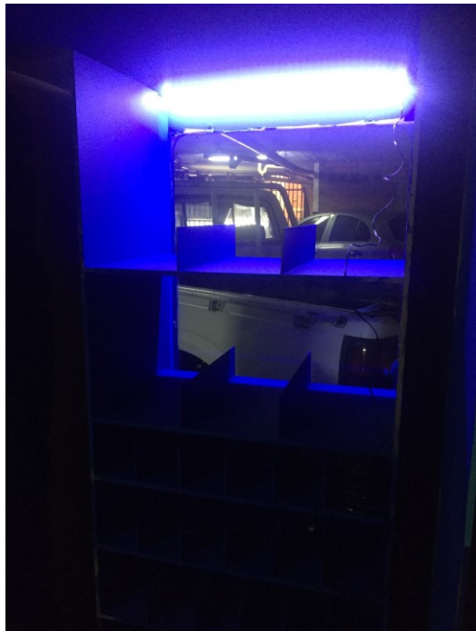
Cinta de leds para iluminación de la máquina dispensadora.
