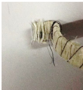
Cubrir abrazaderas con fique y fijarlas al bastidor con tornillos de ensamble de 1/2".
