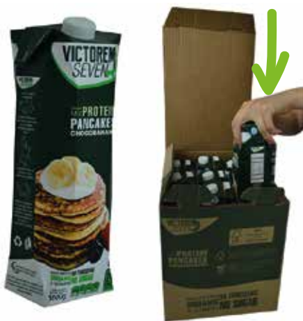
Llenar el embalaje con el producto de a 4 columnas a lo largo 3 filas a lo ancho de manera vertical
