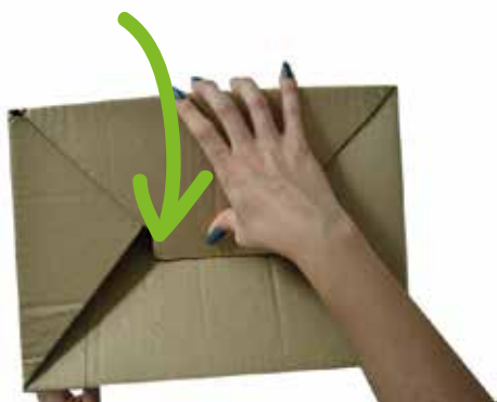
Ensamblar base: llevar cara frontal al centro e insertar hacia adentro
