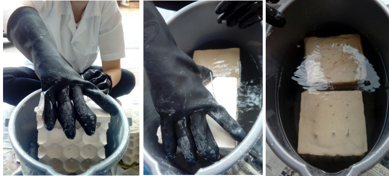
Figura 14. Proceso de disolución de las esferas de poliestireno expandido.
