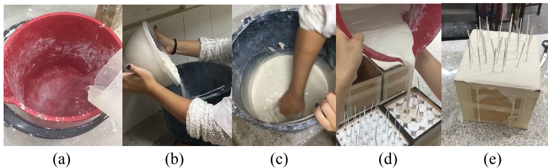
Figura 13. Proceso de preparación y vaciado del yeso. (a) Verter el agua en el balde; b) Agregar el yeso en el agua; c) Revolver la mezcla con la mano sin dejar grumos; d) Verter la mezcla en el molde; e) Probeta secándose.
