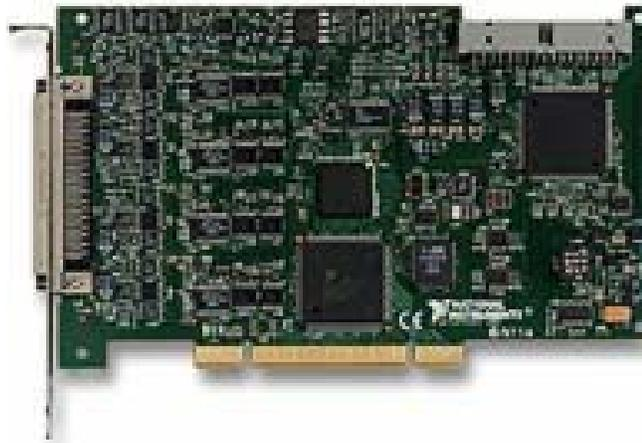
*Figura 174. Tarjeta Generadora.*
