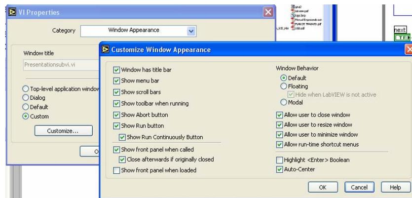
**Figura 81. Ventana de configuración de apariencia de un VI**
