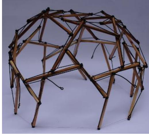
Figura 12 Estructura icosaedrica tensegrity con el método de plegado
