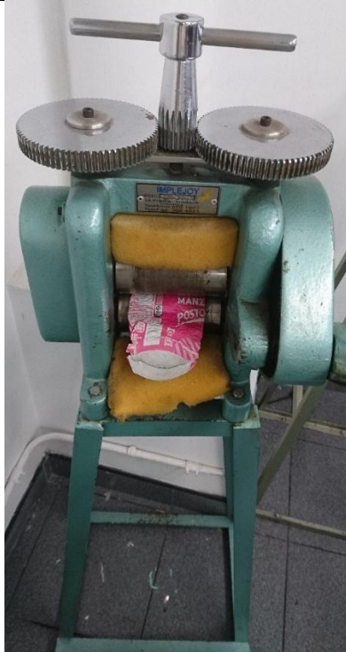
Foto: María A Bonett. (14/10/2016) Imagen 9. Pasar por el laminador, hasta dejarla en un calibre delgado.
