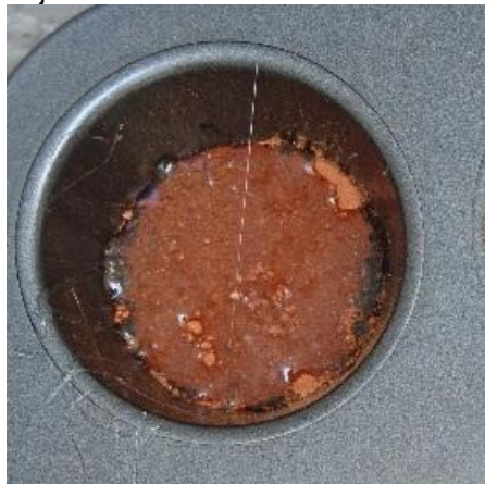
Foto: María A Bonett. (18/10/2016) Imagen 45. Colocar silicona en el molde, poner la mezcla, otra capa de silicona, esparcir y dejar secar.
