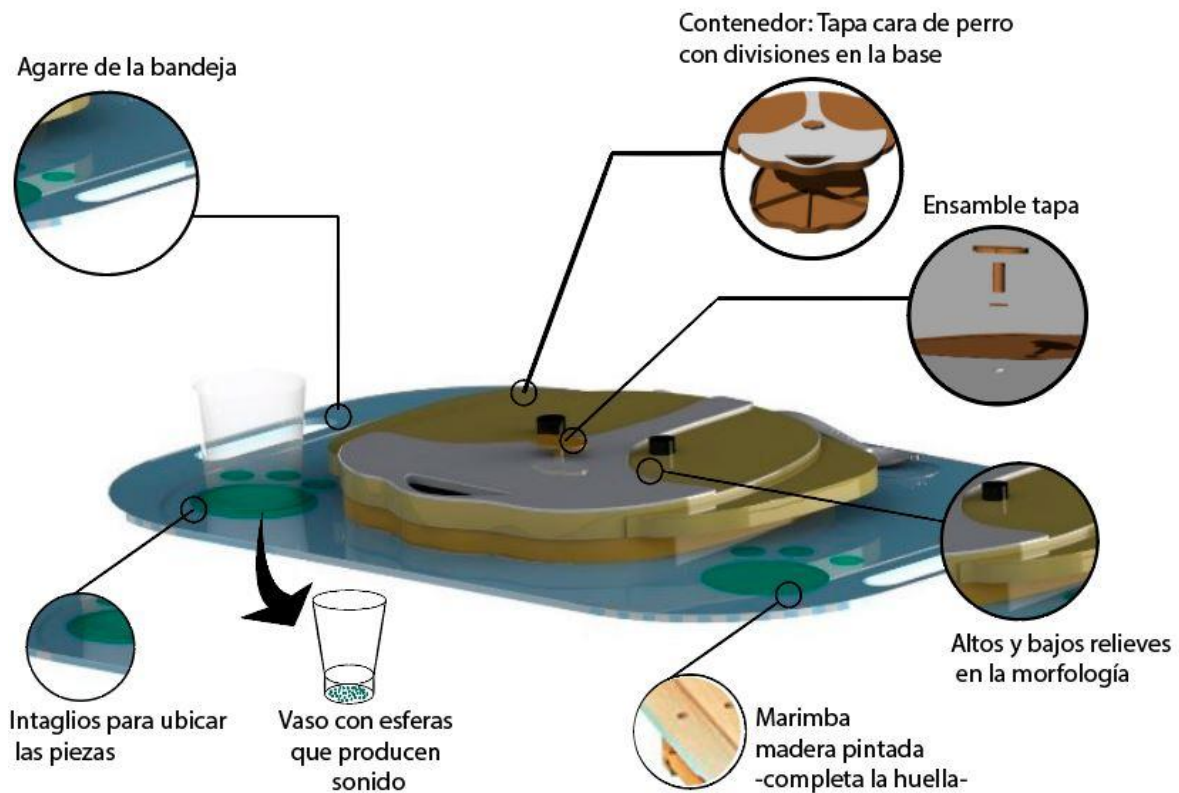
Fig. 4 Producto con lupas donde se evidencia en detalle la morfología y las interfaces de contacto (Desarrollo propio)
