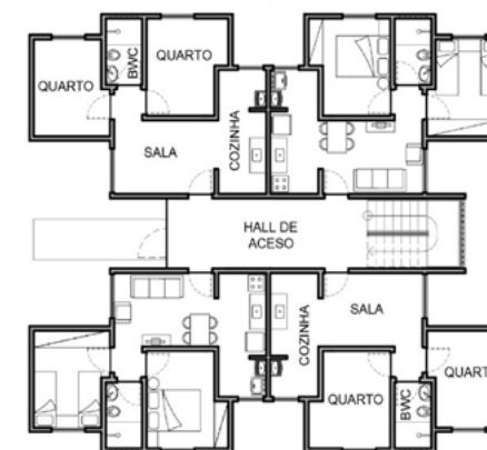
Figura 13. Planta baixa edifício tipo
