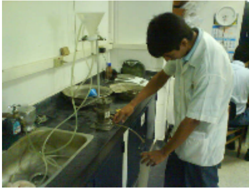
FIGURA 16. ABRIR LAS VALVULAS PERMITIENDO EL PASO DE AGUA Y LA SATURACION DE LA MUESTRA
