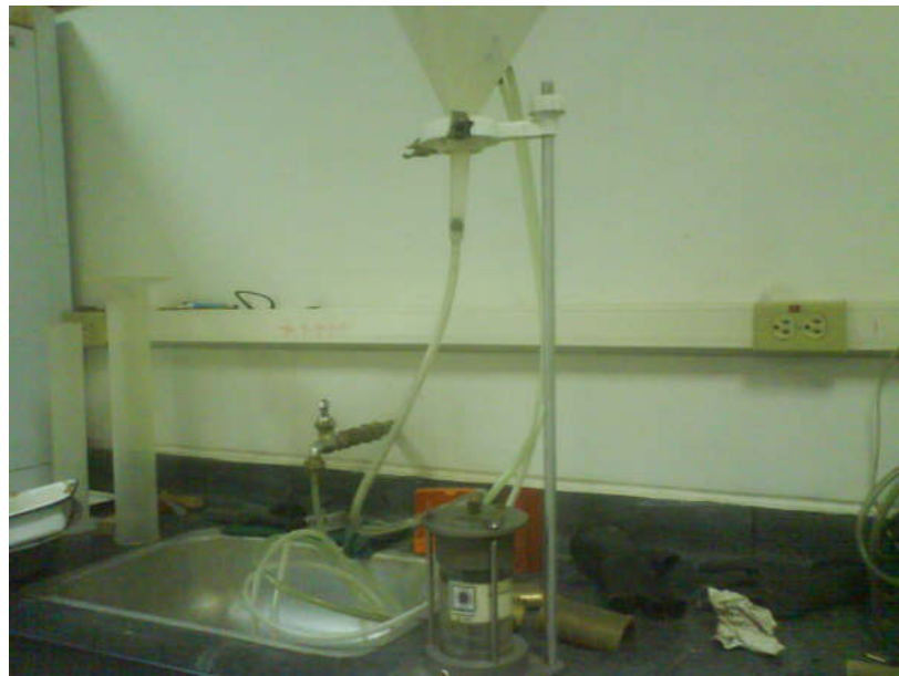
FIGURA 15. CONECTAR LA CAMARA AL APARATO DE PERMEABILIDAD DE CABEZA CONSTANTE
