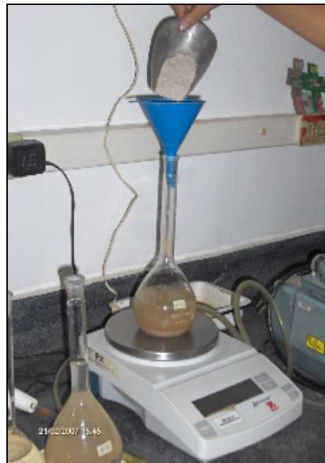
FIGURA 8. ADICION DE LA MUESTRA DE SUELO SELECCIONADA
