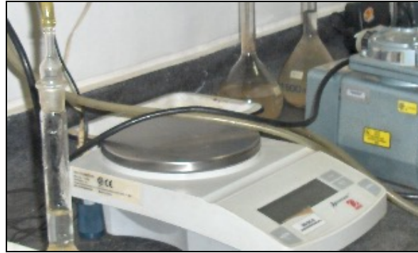
FIGURA. 7 CALIBRACION DEL MATRAZ A DIFERENTES TEMPERATURAS
