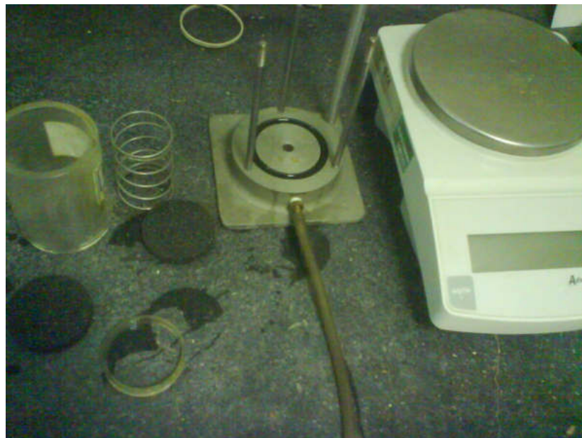
FIGURA 13. PESO DE LA CAMARA Y TODOS LOS ELEMENTOS EN LA QUE ESTARA CONTENIDA LA MUESTRA DE SUELO
