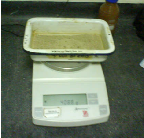
FIGURA. 12 PESO DE LA MUESTRA DE SUELO ANTES Y DESPUES DE LLEVAR AL HORNO
