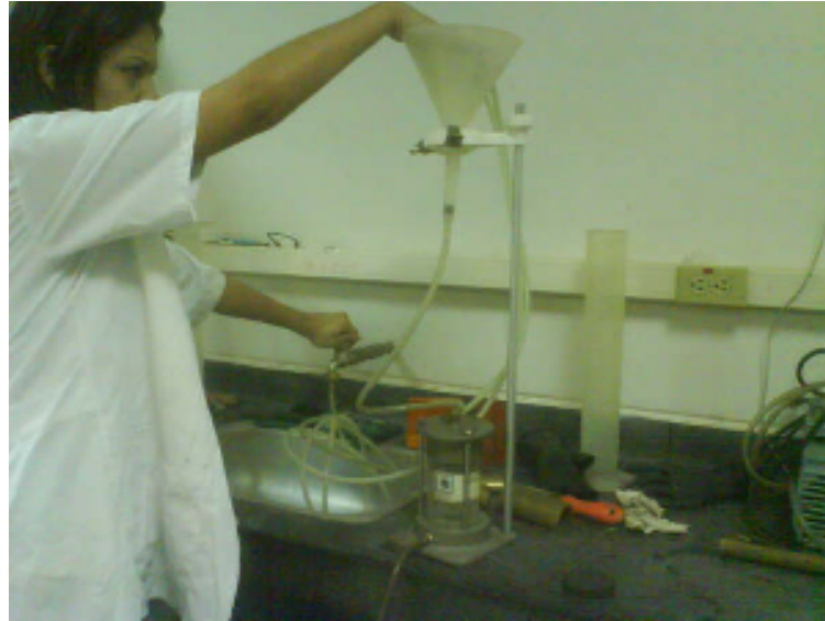
FIGURA 14. ARMAR EL APARATO DE PERMEABILIDAD DE CABEZA CONSTANTE
