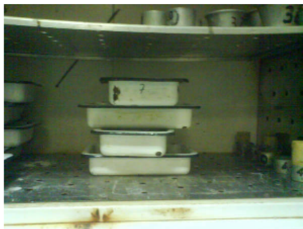
FIGURA 18. PESAR LA MUESTRA DE SUELO ANTES Y DESPUES DE LLEVAR AL HORNO
