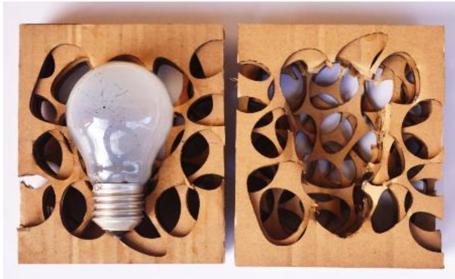
Figura 14. UPB. (2014). Estructura por capas de cartón corrugado. [Fotografía].
