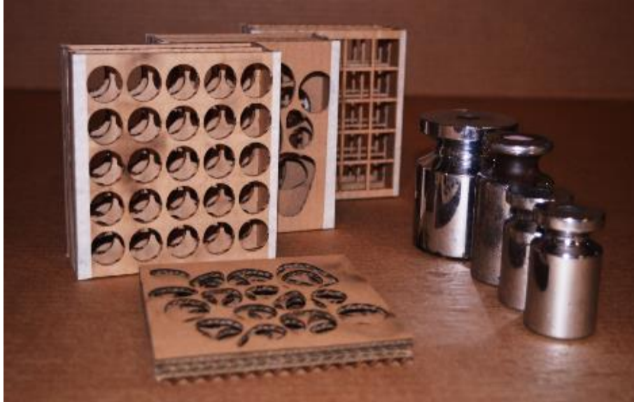
Figura 12. UPB. (2104).Estructuras en cartón corrugado con los patrones geométricos. [Fotografía].
