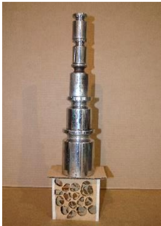
Figura 13. UPB. (2014). Prueba de compresión a estructura voronoi. [Fotografía]
