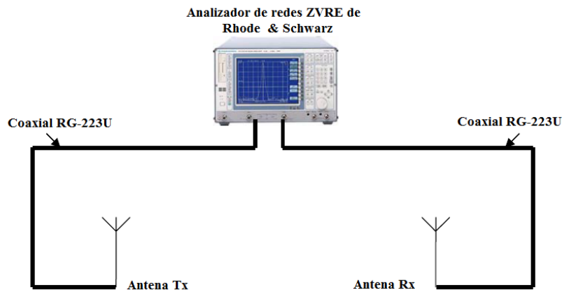
Figura 4.7. Sistema de medidas para la campaña de medidas entre 57 y 66 GHz.
