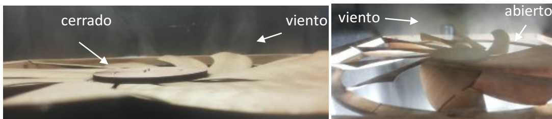
Figura 7 y 8: La imagen de la izquierda muestra el modelo cerrado y como pasa poco flujo de viento, la imagen de la derecha es el modelo abierto y como pasa mucho más flujo de viento
