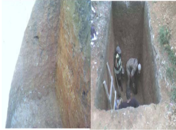
“Apiques del Estudio de Suelo a 7m de la superficie.” 4
