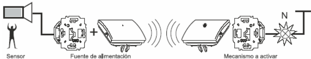
Figura 24. Activación remota de carga a través de sensor
