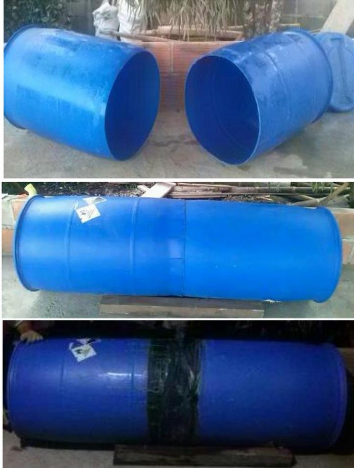
Figura 17. Proceso de fabricación de un tanque longitudinal de 400 L.
