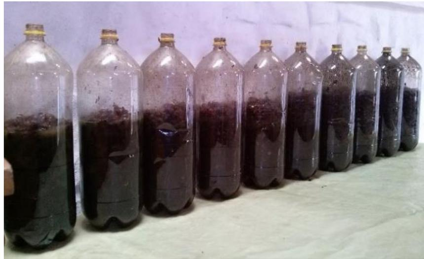
Figura 12. Fotografía de los 10 reactores con el sustrato de pulpa de café, lodo activado y agua, hasta completar volúmenes iguales de 2,5 L aproximadamente.
