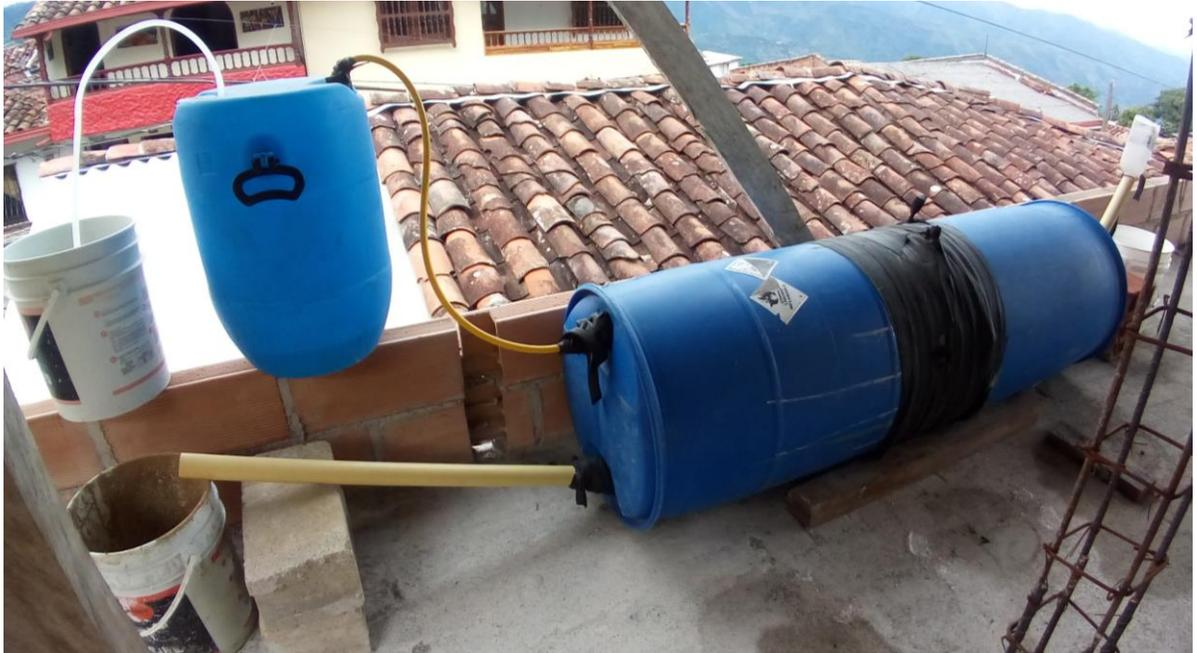
Figura 18. Reactor PFR de 400 L para producción de biogás con pulpa de café como sustrato. Por la derecha ingresa pulpa de café y agua; por la izquierda, en la parte inferior sale lodo estabilizado y por arriba biogás, el cual pasa a un tonel que contiene agua que es desalojada por la presión del biogás y recibida en un recipiente para su cuantificación.
