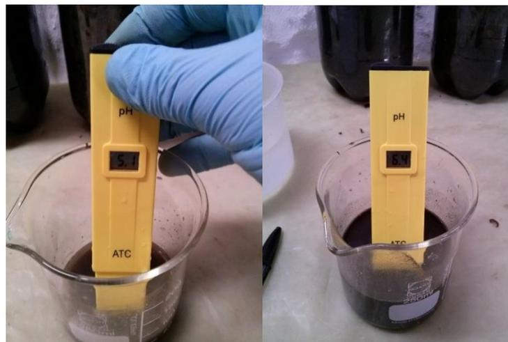
Figura 13. Medición del pH de cada reactor.
