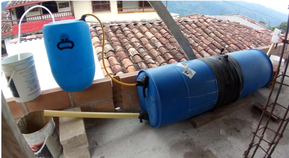
Figura 5. Vista lateral del reactor PFR junto con pulpa de café lista para ser introducida en el sistema.
