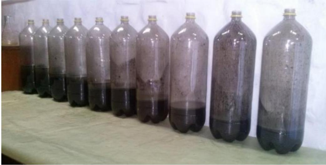
Figura 11. Fotografía de los 10 envases en los que se adicionó agua y lodo activado en cinco diferentes diluciones antes de verter la pulpa de café.
