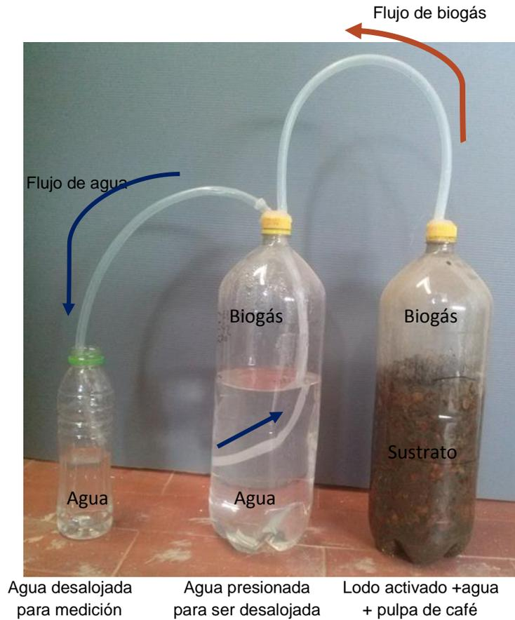
Figura 10. Modelo de reactor anaeróbico discontinuo o por lotes, alimentado con lodo activado, agua y pulpa de café como sustrato, para la producción de biogás y su respectiva cuantificación por el método de desplazamiento de líquido.
