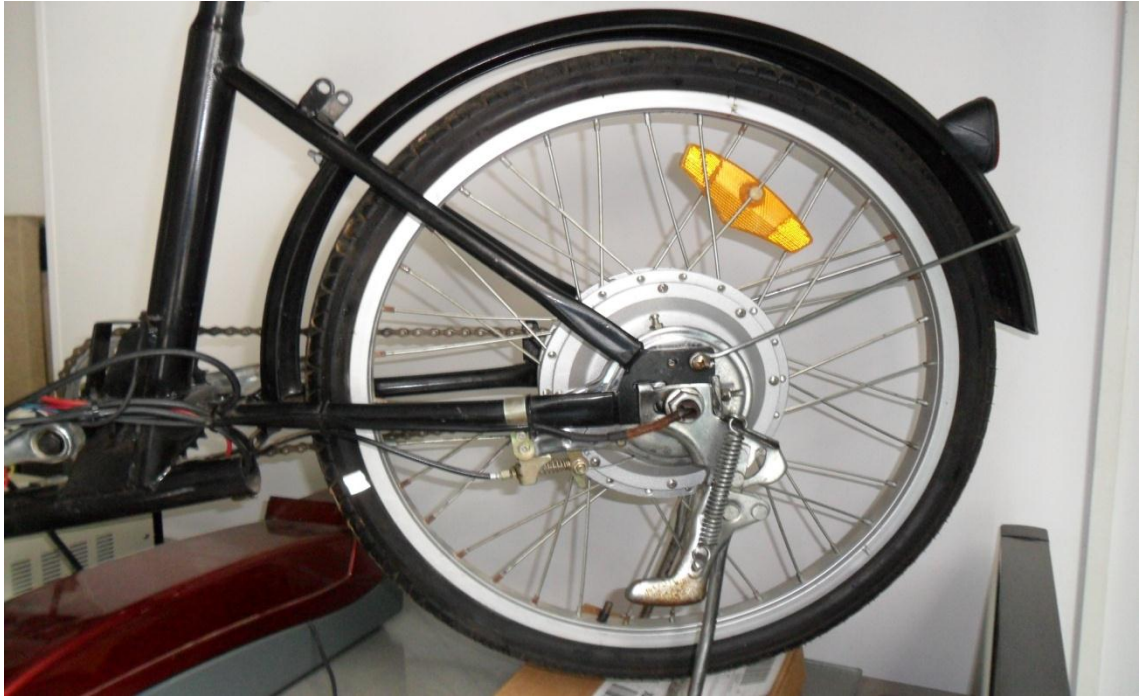
Figura 25 Motor BLDC acoplado a llanta de bicicleta.
