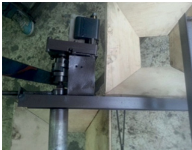
Anexo 2. Motor- reductor para la banda con dos tolvas.
