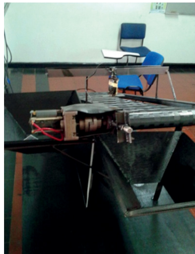
Anexo 8. Sistema eléctrico para el electroimán y la banda.
