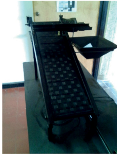
Anexo 7. Banda transportadora terminada.
