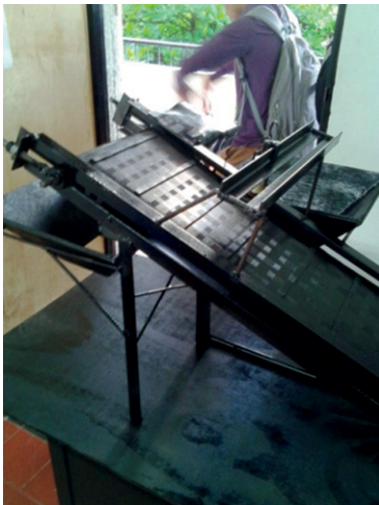
Anexo 6. Banda transportadora terminada.
