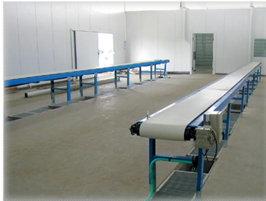
Ilustración 2. Bandas transportadoras.
