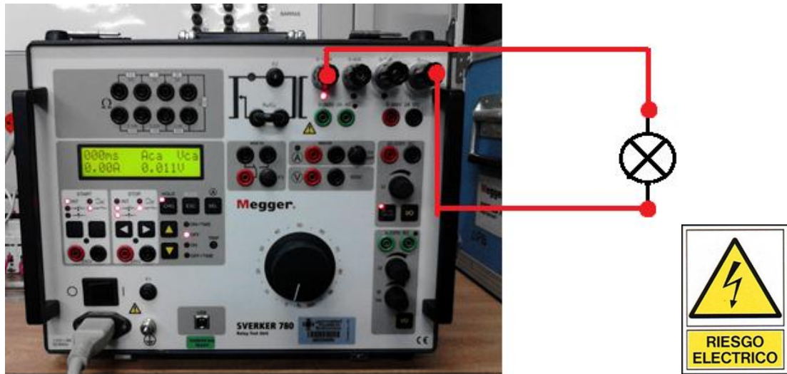
Figura 13. Conexión entre el SVERKER y el banco de bombillos
