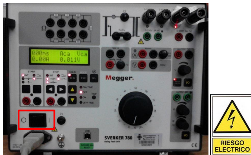
Figura 1. Energización del SVERKER 780
