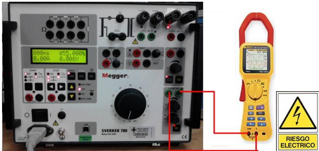
Figura 8. Conexión del analizador a fuente auxiliar de Vac
