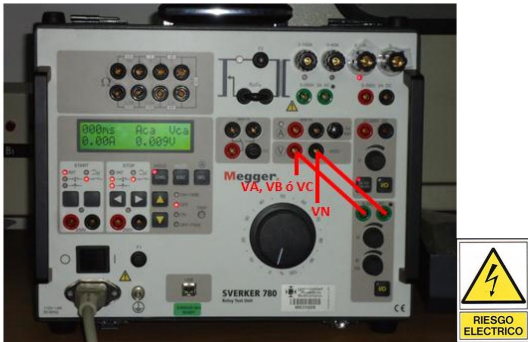
Figura 48. Conexión del SVERKER 780 con el IED SEL 751A
