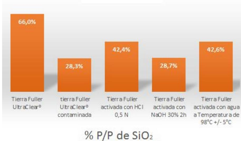
**Figura 6:** Porcentaje P/P de  $\text{SiO}_2$  de las Tierras Fuller activadas, UltraClear® y UltraClear® contaminada.
