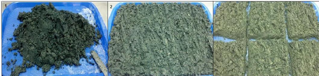
**Fotografía 2:** Procedimiento de cuarteo realizado a la tierra Fuller contaminada.
