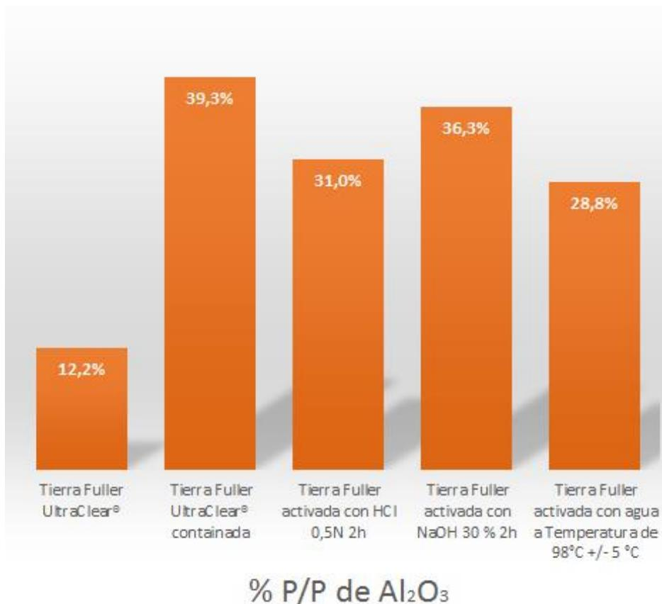
**Figura 7:** Porcentaje P/P de Al<sub>2</sub>O<sub>3</sub> de las Tierras Fuller activadas, UltraClear® y UltraClear® contaminada.
