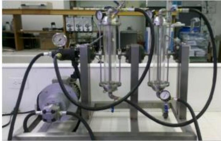
**Fotografía 1:** Equipo de adsorción tipo torres de percolación del Laboratorio Ambiental del GIA
