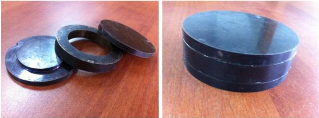
Figura 3.4. Molde utilizado para el proceso de compresión en caliente
