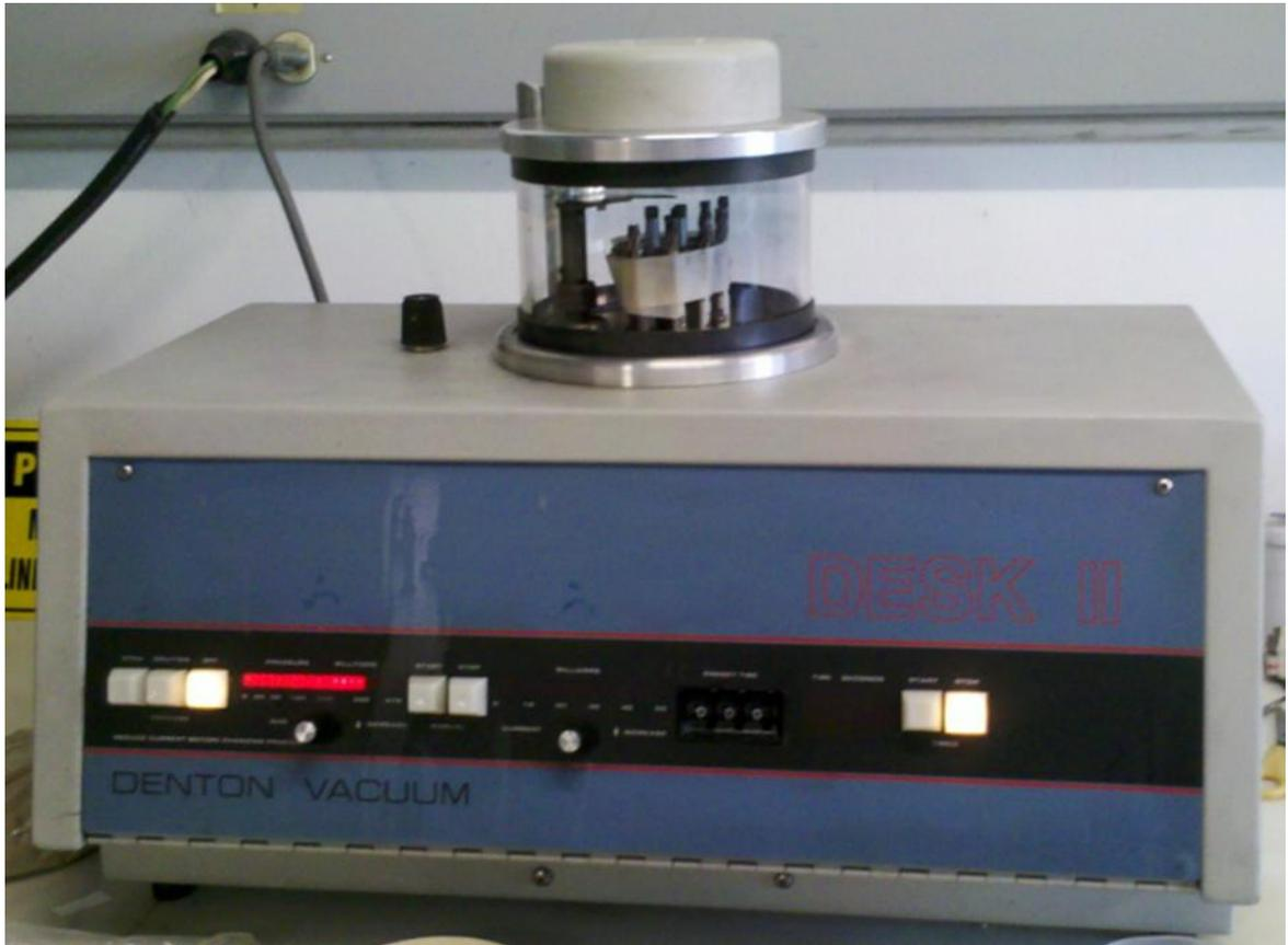
**Figura 3.12. Equipo utilizado para la deposición de oro en la superficie de los pines.**
