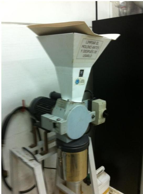
**Figura 3.1. Molino Retsh. Máquina utilizada para moler las fibras de plátano.**
