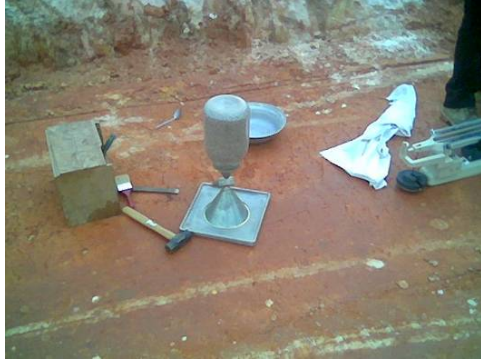
Imagen # 2: Ensayo de densidad cono y arena
