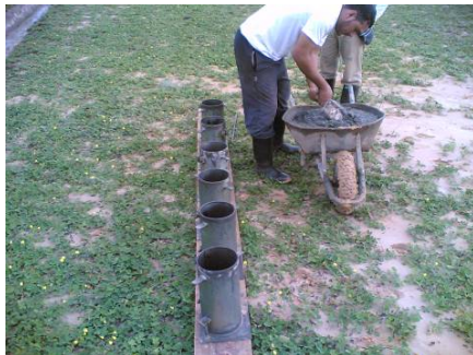
Imagen # 4: Toma de muestras de concreto
