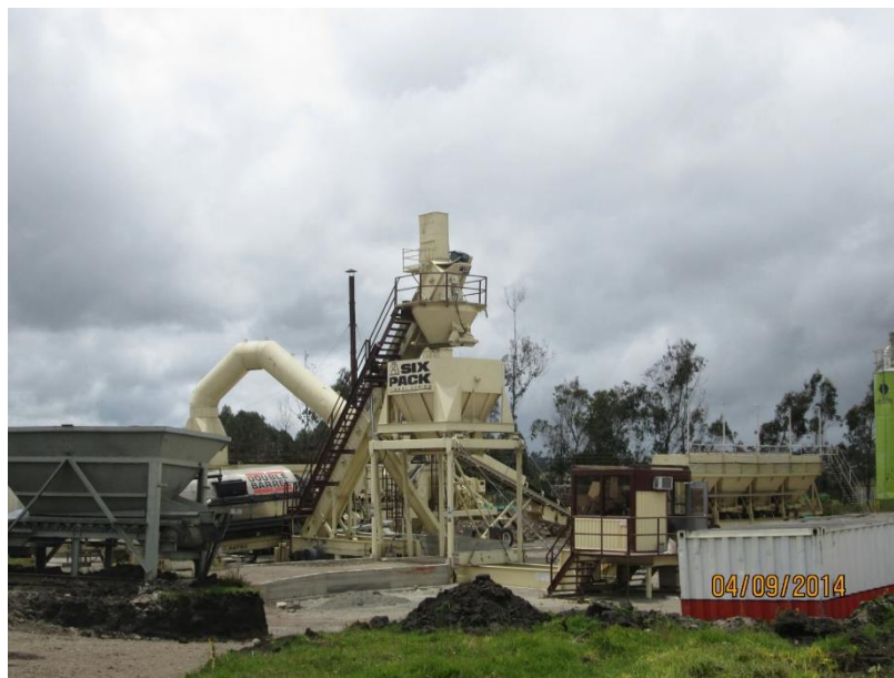
Figura 15. Elevador de mezcla, tolva antisegregación, tolva de pesaje y sala de control Fuente: SONACOL S.A.S., 2014
