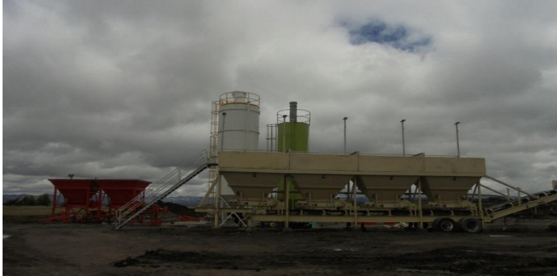
Figura 16. Dosificador de Agregados Fuente: SONACOL S.A.S 2015
