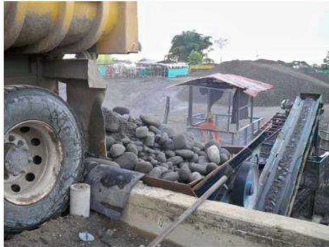
Figuras 3. Alimentación, banda transportadora y primer método de clasificación vibratoria y trituración Fuente: SONACOL SAS, 2015
