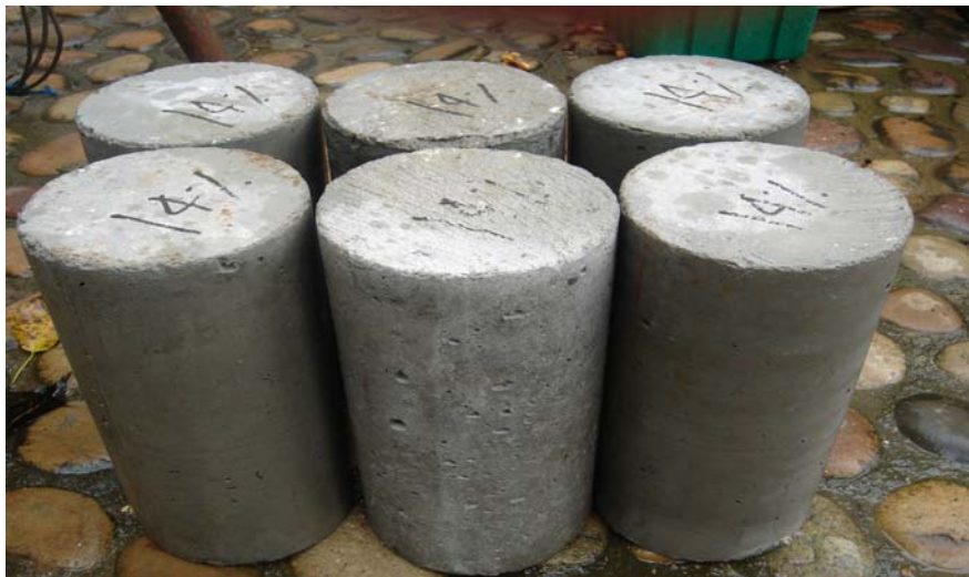
Figura 4. Muestras de Cilindros con 12% de Adición de Viruta de Acero.
