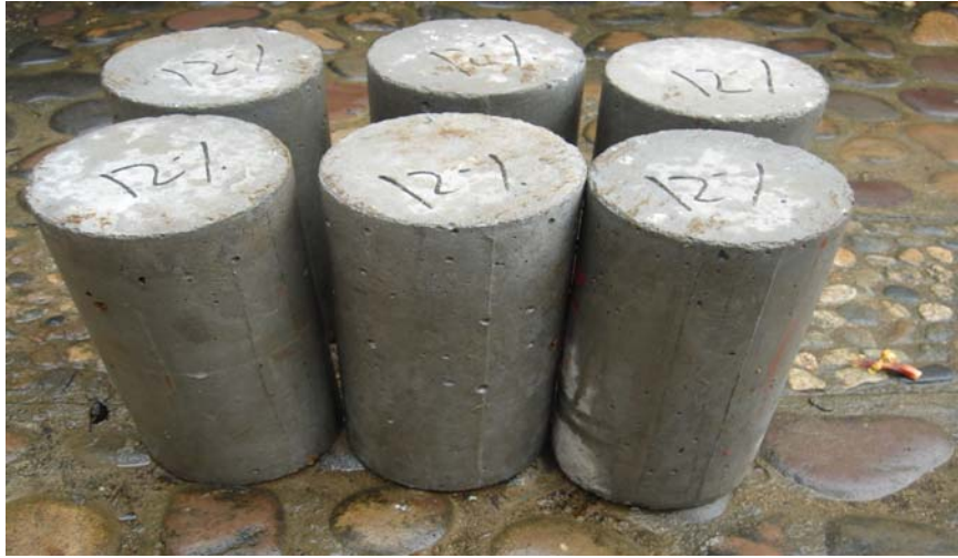
Figura 4. Muestras de Cilindros con 12% de Adición de Viruta de Acero.
