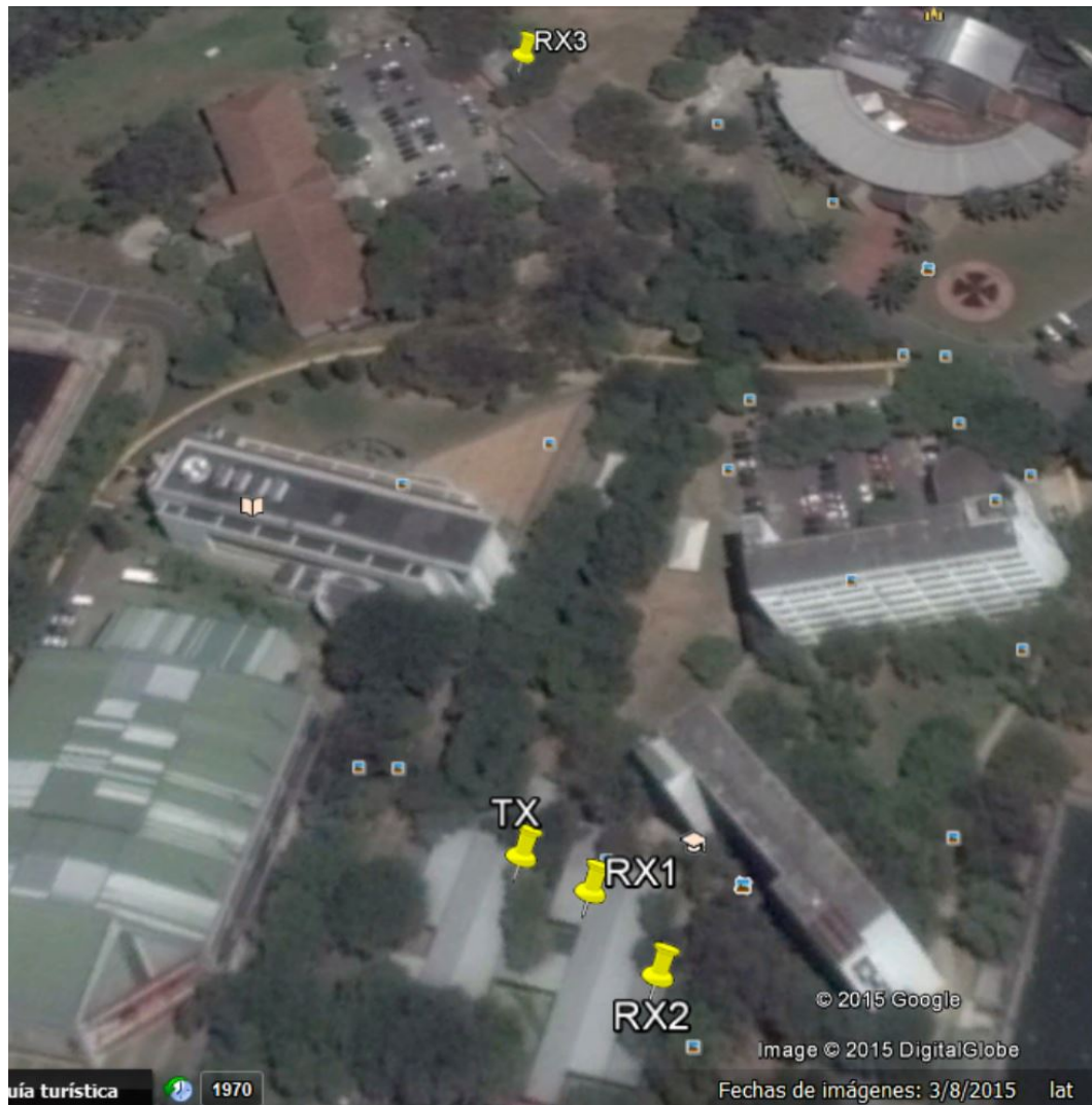
Figura 3.17: Ubicación de transmisor y receptor en prueba de campo
