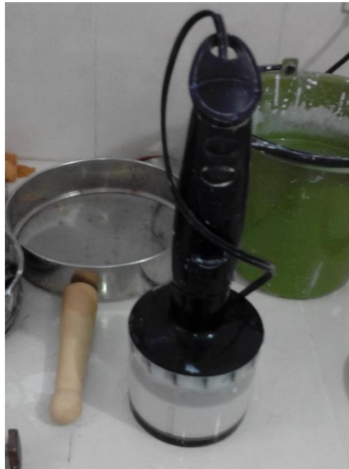
Figura 4. Preparación de las mezclas de arcillas, caolines, feldespato, cuarzo y otros aditivos. Los diferentes componentes se mezclan con agua y se disuelven con la ayuda de un agitador (batidora).
