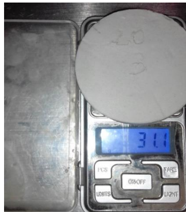
Figura 8. Ilustración de prueba de pérdidas por ignición. Se registra la masa de las muestras antes y después de la cocción en el horno.
