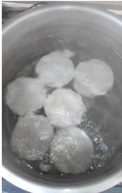
Figura 5. Ilustración prueba de absorción. Las muestras se llevan a ebullición en agua durante un período de 2 horas.
