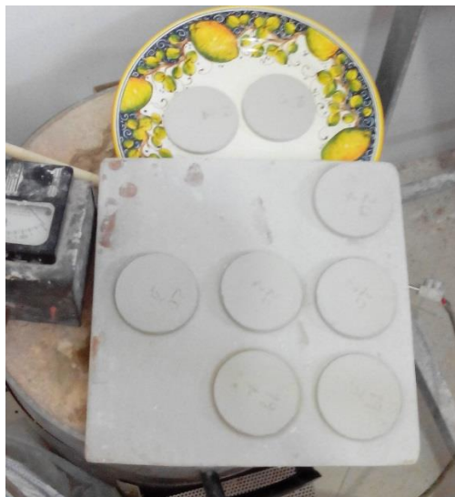
Figura 6. Ilustración de muestras prueba de contracción al secado. Las muestras se arman con la ayuda de un aro metálico de perímetro fijo. Las muestras se secan, y así poder registrar el perímetro antes y después del secado.
