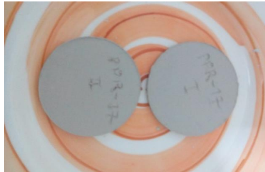
Figura 7. Ilustración de prueba de contracción a la quema. Se registra el perímetro de las muestras antes y después de la cocción en el horno.
