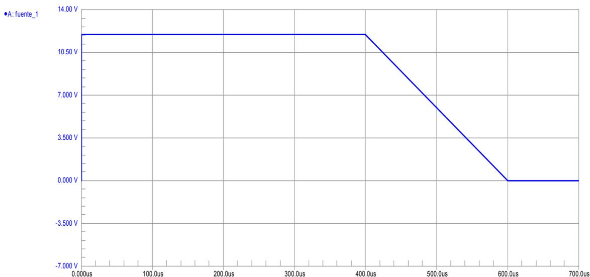
Fig. 2.27. Señal de salida de la fuente con LM317 con carga. Fuente: Autor
