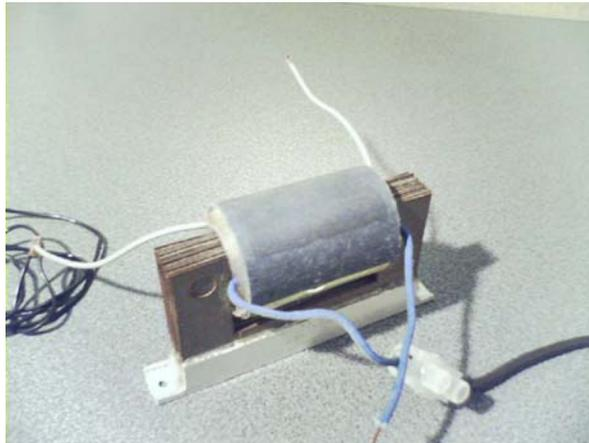
Fig. 2.29. Foto del transformador elevador de alto voltaje. Fuente: Autor
