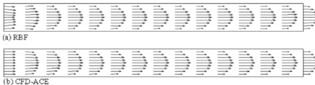
Fig. 11 canal con obstáculo al usar RBF vs CFD tomado de [9]
