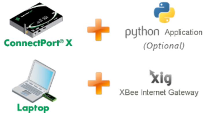
Figura 5.2: Elementos para subir los datos de un Xbee a la nube a través de Cloud. [33]
