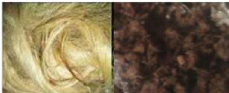
**Figura 8.** Fique antes y después del *steam explosion*.
