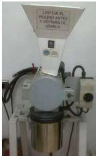
**Figura 4.** Molino de cuchillas Retsch.
