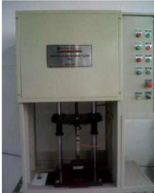
**Figura 6.** Maquina universal de ensayos.
