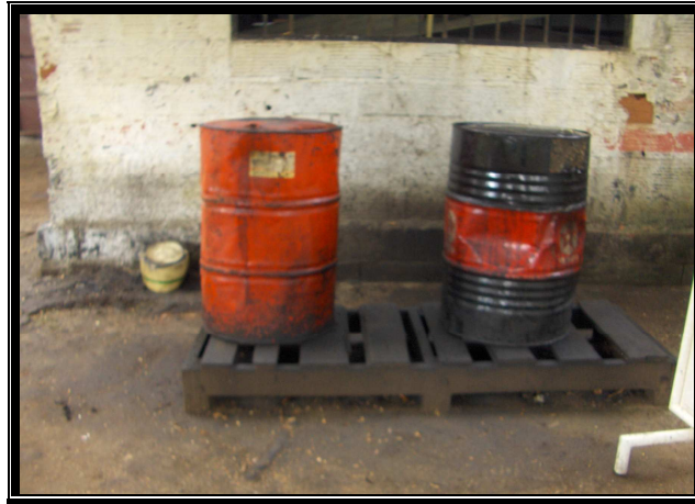
Figura 8. Manejo Inadecuado De Residuos Líquidos Peligrosos En La Sección De Mecánica De La ENAP, 2007 y 2008
