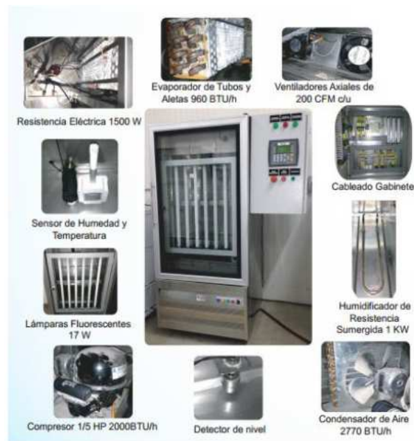
Figura 1. Cámara de ambiente controlado . Tomado de Cardona et al. (2013)
