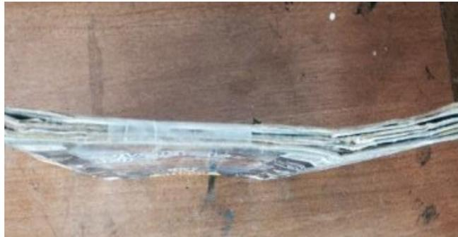
Luego de que las configuraciones fueron prensadas bajo las condiciones descritas anteriormente, fueron cubiertas con silicona líquida en los bordes evitando la absorción de humedad, esto debido a que estudios realizados han demostrado que las propiedades de las configuraciones realizadas a partir de Tetra-Pak son afectadas de forma
