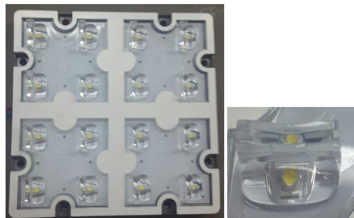
Figura 23. Módulo y lente LED
