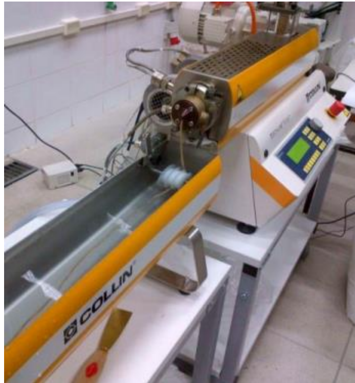
Figura 2.2 Configuración del extrusor para peletizar compuesto PP/GAK
