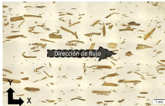
Figura 3.9 Fotomicrografía de sección de análisis a través del plano x-y. Se observan las fibras en su totalidad.
