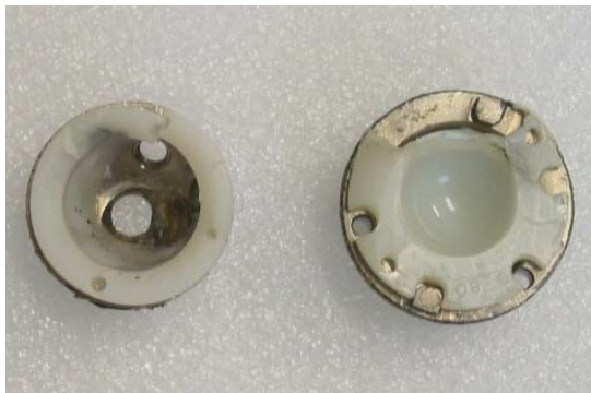
Gráfico 29. Desgaste producido sobre acetábulos de polímero en prótesis de cadera. Tomado de [48]
