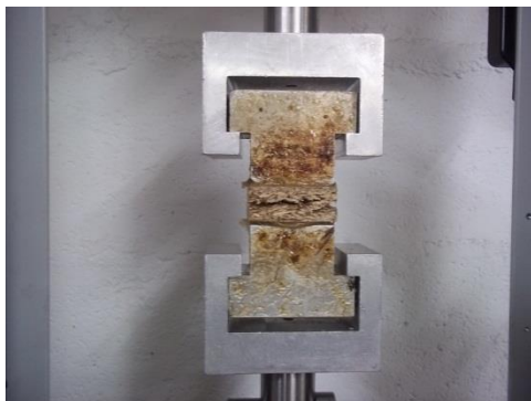
Figura 4. Ruptura de la probeta
