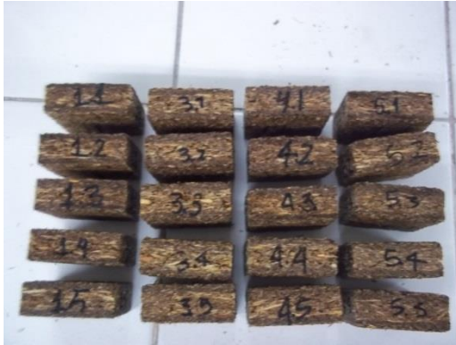
Figura 1. Probetas luego de 24 h de inmersión en agua fría
