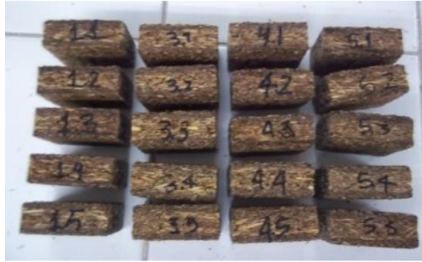
Ilustración 6. Probetas sometidas a pruebas de absorción e hinchamiento
