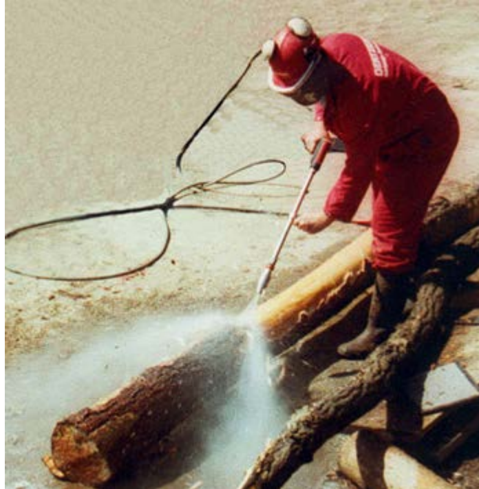
Figura 3. Descortezado de madera empleando agua a presión.
