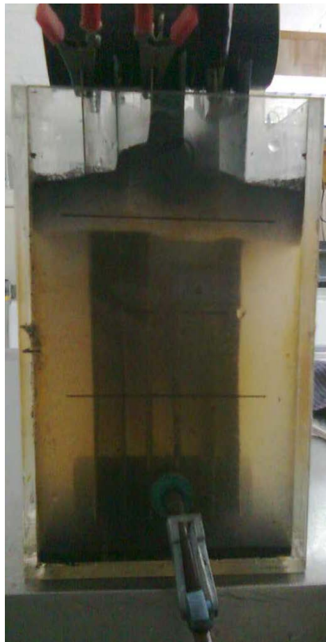
Figura 7. Fotografía montaje electrocoagulación en proceso de remoción de color y DQO. Fuente: Tomada por Sebastián Cardona Gómez. Barbosa, Antioquia 2010.
