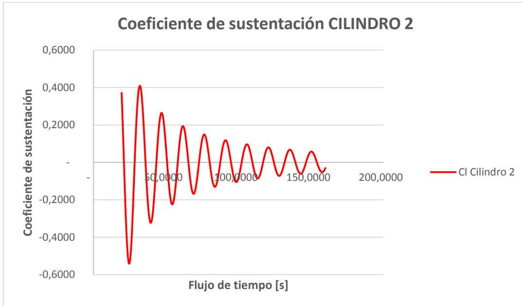
Figura 73. Coeficiente de sustentación cilindro 2; configuración lineal, 2 cilindros, P/D=2,5.
