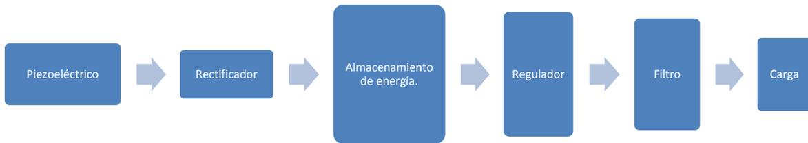
Figura 59. Esquema conceptual del tratamiento eléctrico.
