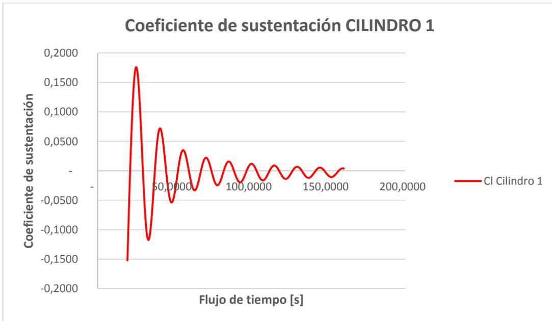
Figura 72. Coeficiente de sustentación cilindro 1; configuración lineal, 2 cilindros, P/D=2,5.
