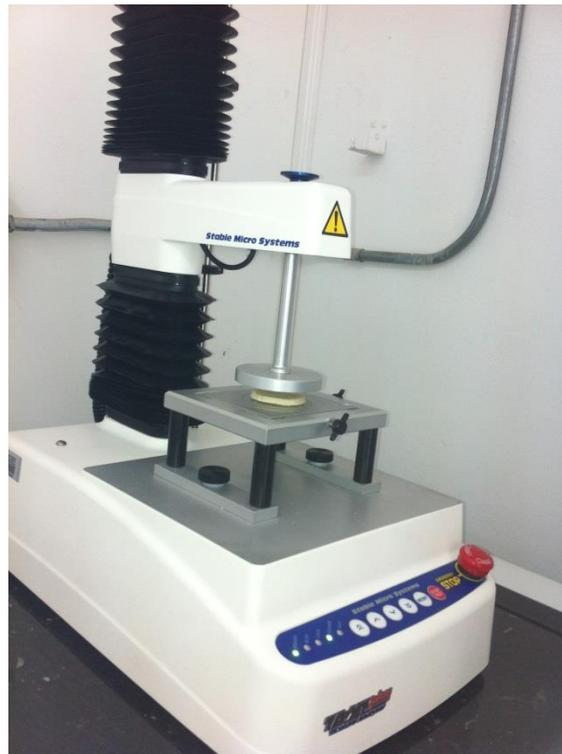
**Ilustración 9.** Texturómetro con montaje para TPA
