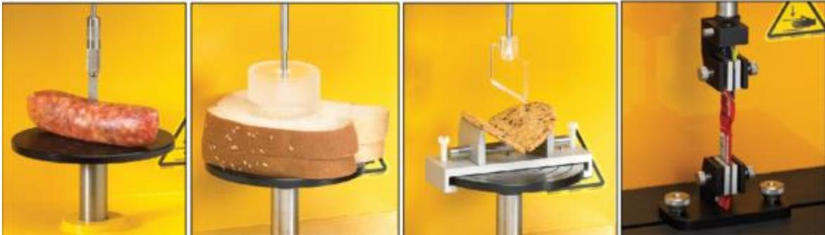
**Ilustración 4.** Algunas pruebas instrumentales para medir propiedades de textura en alimentos (Freeman, 2010). De izquierda a derecha se presentan pruebas de: Penetración, compresión, corte y tensión.
