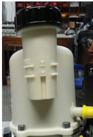
Figura 16. Depósito de aceite bomba electrohidráulica del proyecto (Betancur & Giraldo, 2013).
