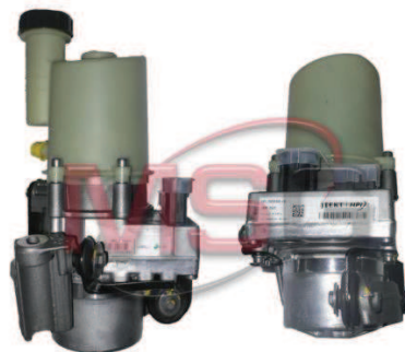
Figura 14. Bomba electro-hidráulica Renault Logan 1.5 dci (Betancur & Giraldo, 2013).
