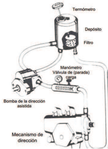
Figura 17. Esquema para pruebas hidráulicas (TRW Automotive INC, 2009).
