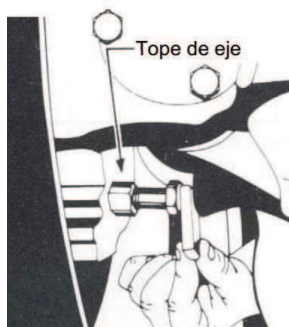
Figura 18. Bloque separador de acero entre el tope del eje y la rueda (TRW Automotive INC, 2009).
