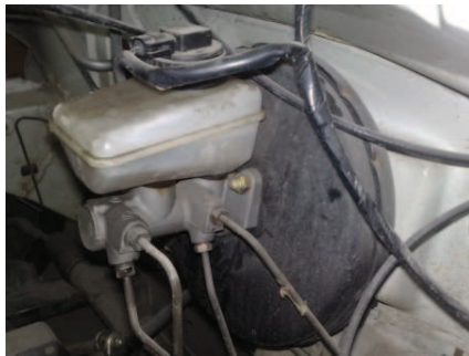
Figura 1. Sistema de frenos ( booster y bomba de freno).
