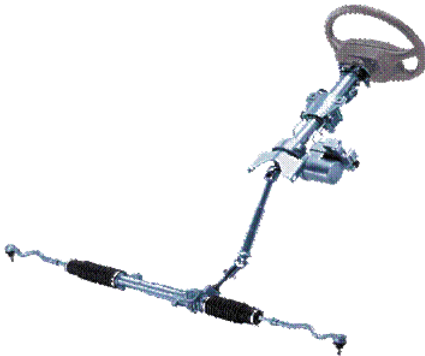
Figura 12. Columna de dirección con bomba hidráulica (Argote Espinoza, 2014).
