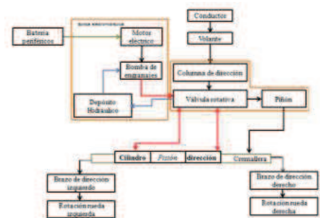
Figura 3. Diagrama de flujo del sistema de dirección del Logan eléctrico [3].
