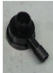
Figura 27. Válvula de retención del acumulador.
