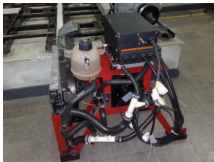
Figura 1. Sistema de frenos ( booster y bomba de freno).
