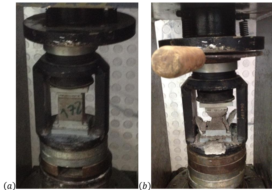
Figura9. Prueba a Compresión de cubos de mortero (cemento y cemento-ceniza)
