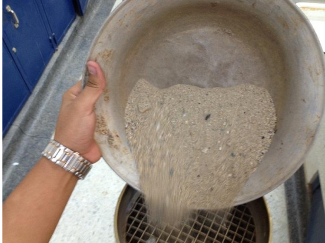
Figura 1 Ejecución del ensayo de granulometría
