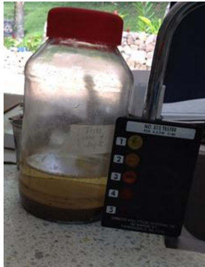
Figura 13. Ensayo de contenido de materia orgánica en arena
