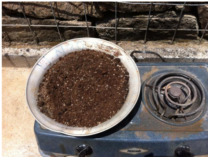
Figura 19. Secado del suelo mediante hornilla eléctrica
