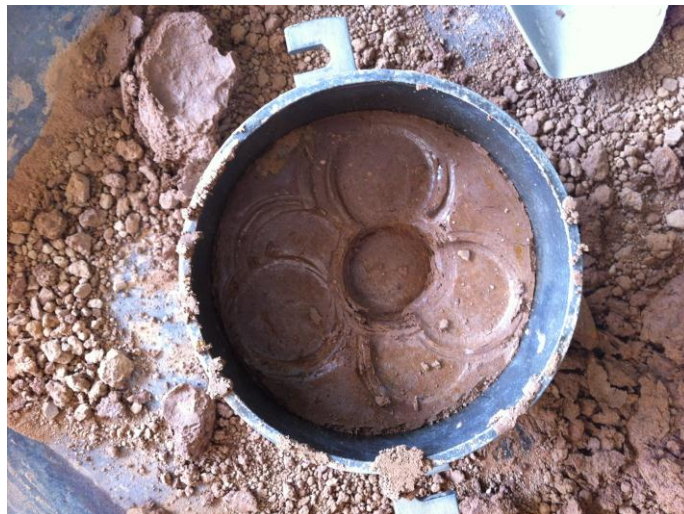
Figura 21. Suelo compactado con martillo de hierro.
