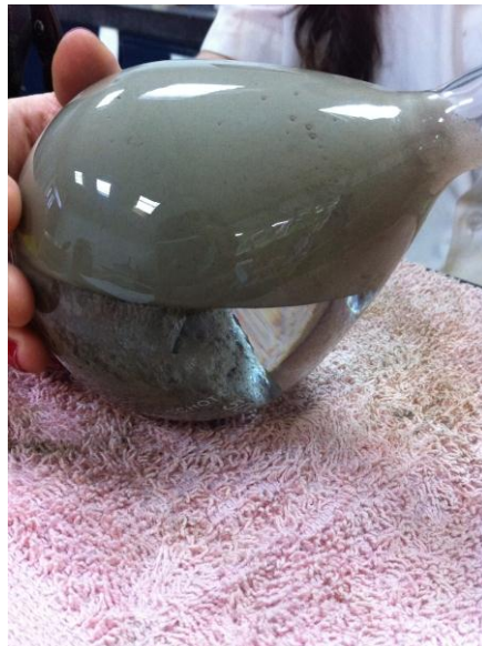
Figura 17. Rotación de picnómetro con suelo impermeable
