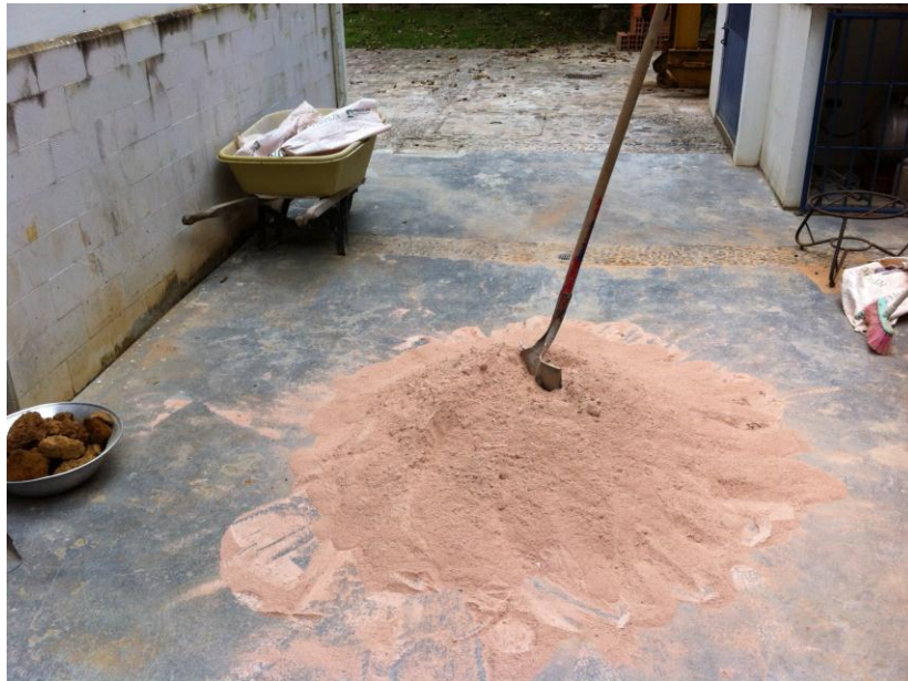
Figura 11. Suelo ajustado con 45% de SC y 55% de caolín
