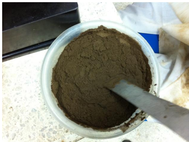
Figura 31. Mezcla de suelo impermeable.
