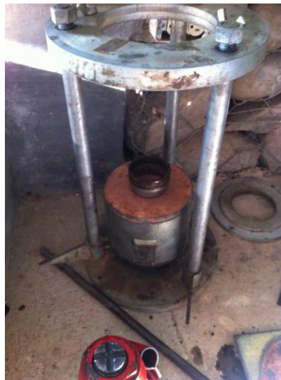
Figura 26. Introducción de molde mediante gato hidráulico.
