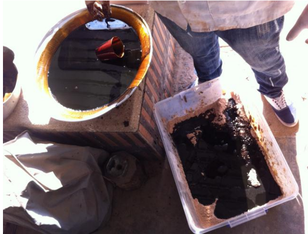
Figura 14. Proceso de mezclado del suelo con el hidrocarburo
