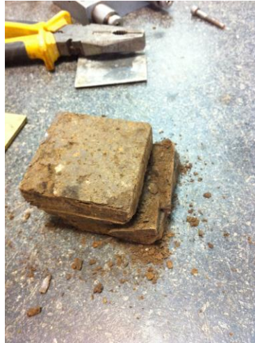
Figura 25. Muestra fallada y retirada de la caja de corte directo.
