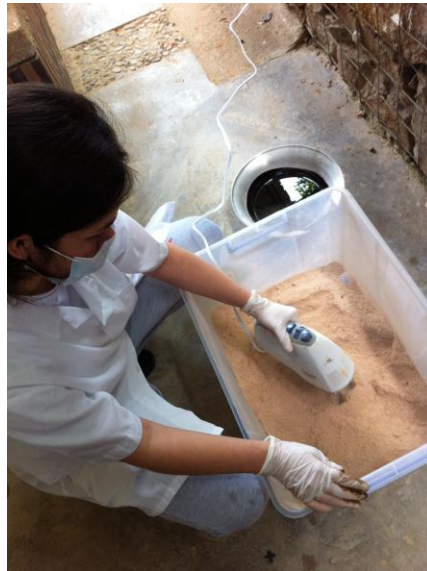
Figura 12. Inicio Mezcla del suelo mediante batidora
