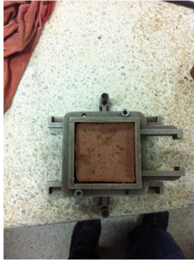
Figura 23. Muestra de suelo dentro de caja de corte directo.
