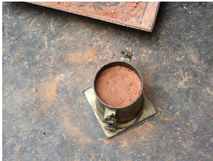
Figura 22. Compactación terminada por disminución de volumen.
