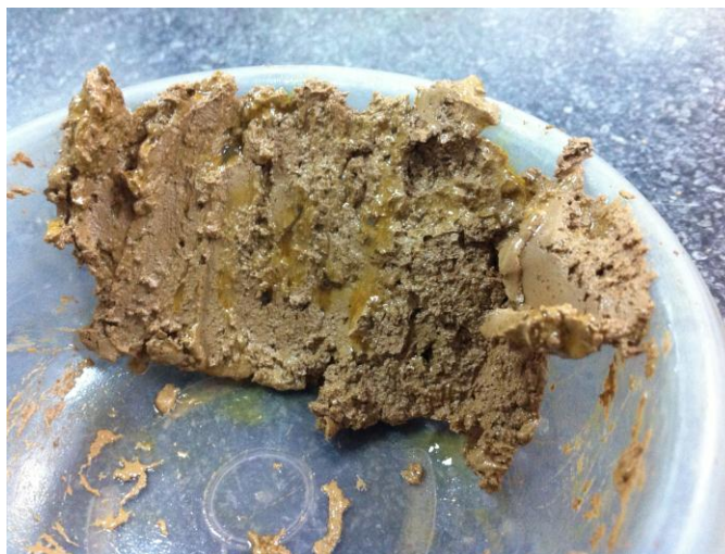
Figura 33. Expulsión de hidrocarburo durante la mezcla.
