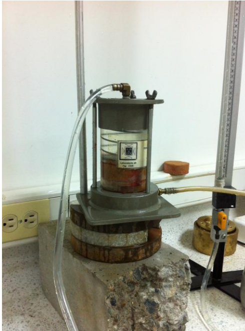
Figura 28. Montaje terminado de Equipo de permeabilidad
