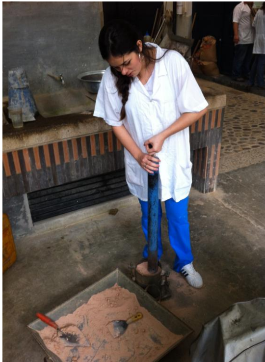
Figura 20. Compactación de suelo mediante martillo de hierro.
