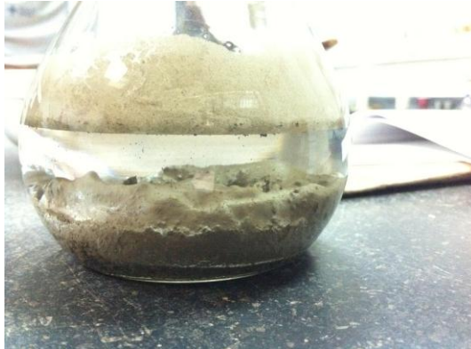
Figura 16. Picnómetro con suelo contaminado impermeable
