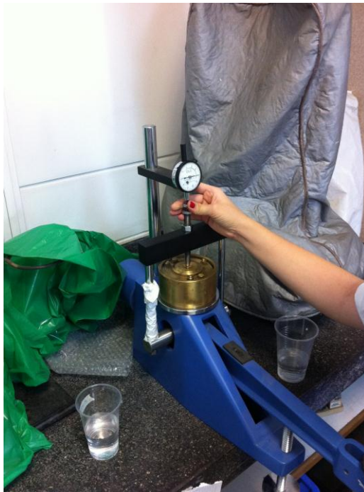
Figura 29. Ajuste del dial en el equipo de consolidación.
