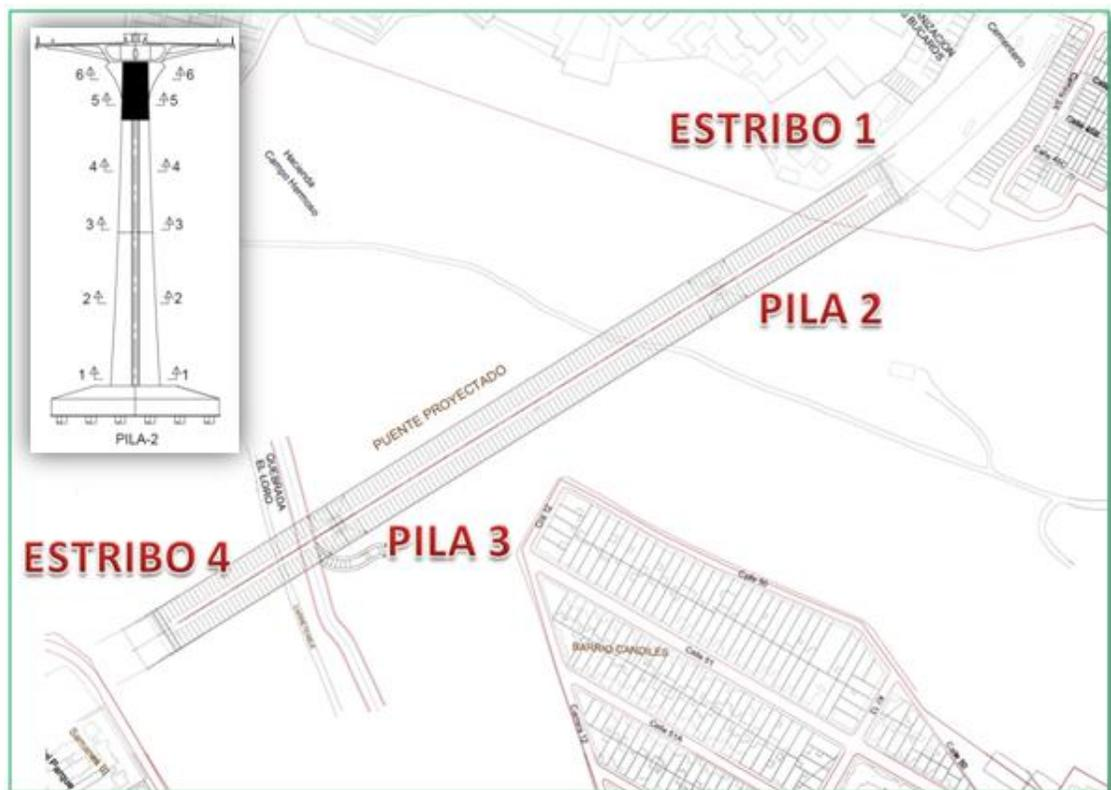
Pila 2, es una estructura de 51.92 metros de altura, la cual está constituida por 700 m<sup>3</sup> de concreto de alta resistencia y 240 toneladas de acero. Se encuentra apoyada sobre una zapata en forma piramidal de 25.5m x 25.5m x 4.5m, la cual está soportada en 36 pilotes de 1.5m de diámetro por 21m de profundidad.
