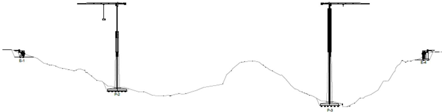
**Figura 8. Fase 5: Construcción de Dovela sobre pila.**
