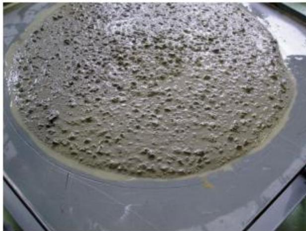
**6.1.4.3 Viscosidad.** La viscosidad es un parámetro que se puede estimar durante la realización del ensayo de fluidez, indicando que tan pastosa se encuentra la mezcla, este ensayo se puede estimar , mediante la medición del tiempo que toma el concreto para extenderse hasta un diámetro de 500mm , desde el momento en
