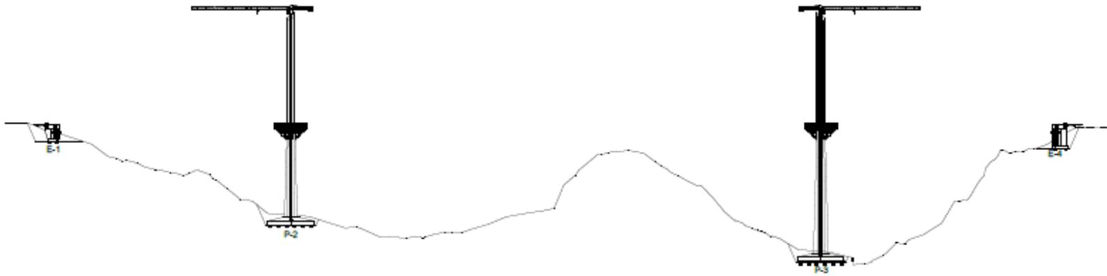
**Figura 9. Fase 6: Colocación de los carros para construcción de Dovela-1, Construcción de Dovela-1 y colocación del Tirante-1**
