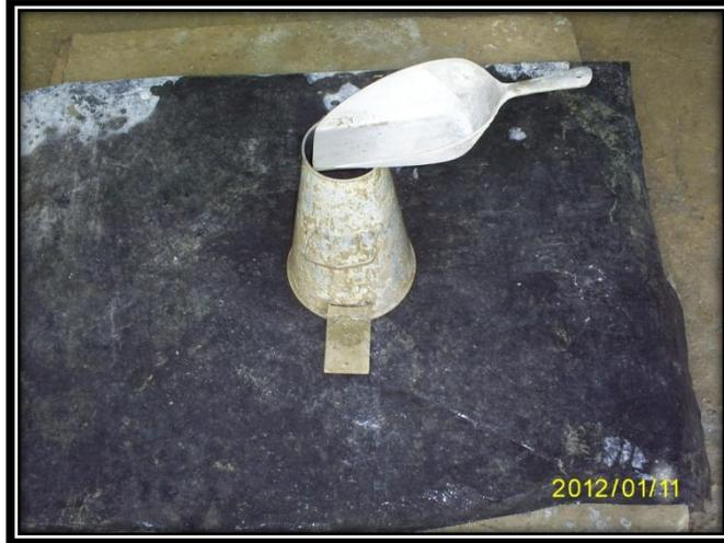
**Foto 8. Levantamiento del cono de Abrams**
