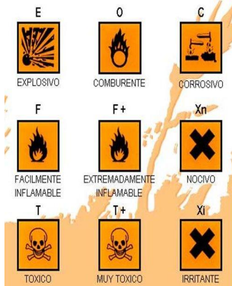
Figura 2. Etiqueta de Sustancias Peligrosas
