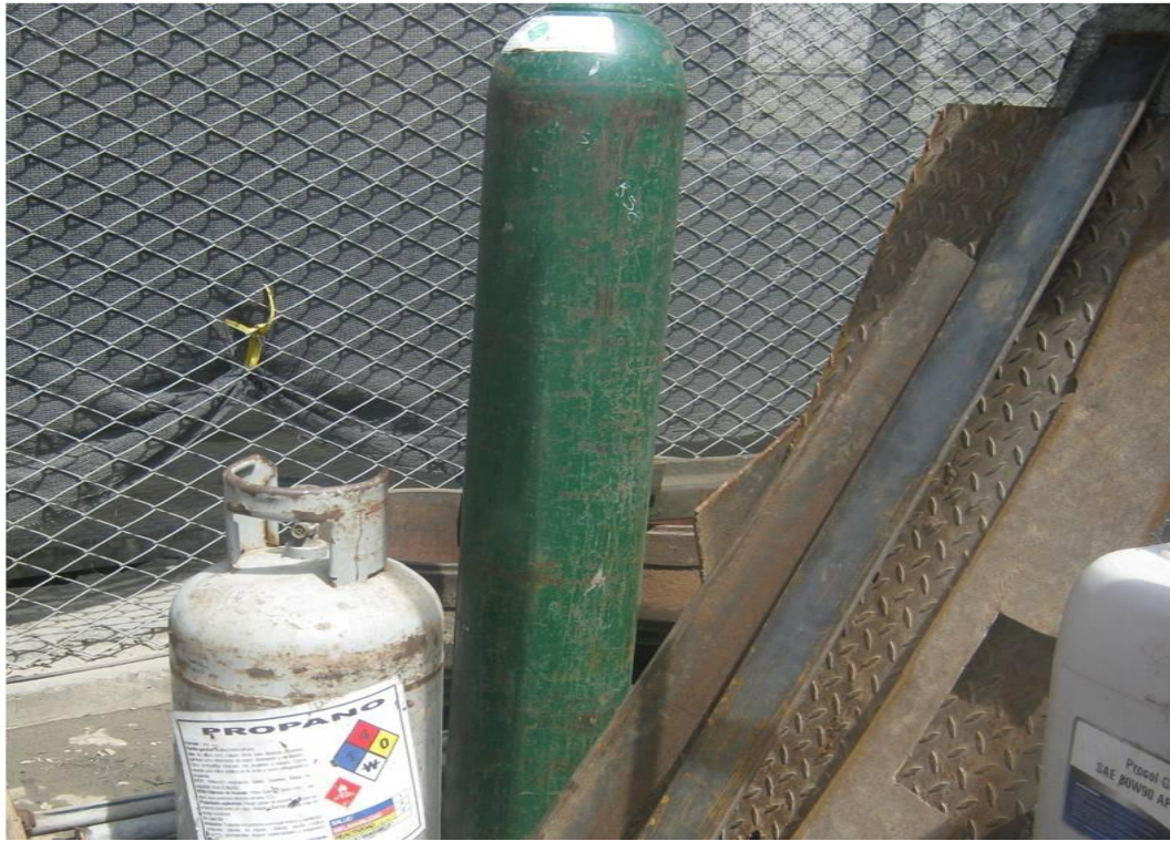
Fotografía 24. Cilindros en inadecuado almacenamiento
