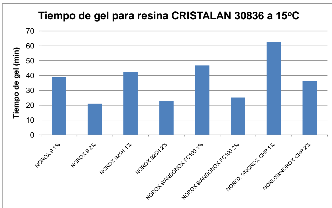
Figura 24. Comparación de tiempos de gel para diferentes peróxidos orgánicos en la resina CRISTALAN 30836 a 15°C.
